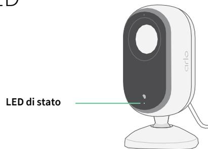
Il LED sulla telecamera si illumina quando la telecamera è accesa. Il LED cambia colore e lampeggia per indicare lo stato di attività, come l'associazione della telecamera e l'aggiornamento del firmware della telecamera.
