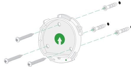
4. Platzieren Sie die Wandplatte so, dass der Pfeil nach oben zeigt, und befestigen Sie eine Schraube in jedem Loch.
