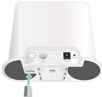
2. Drücken Sie auf die Kante der microSD-Karte, bis sie vollständig im Steckplatz sitzt.
