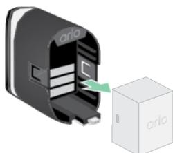
4. Allinea la batteria e inseriscila nel vano batteria. La batteria può essere inserita in un solo modo.
