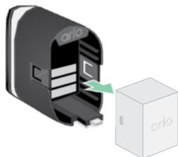
4. Allinea la batteria e inseriscila nel vano batteria.
